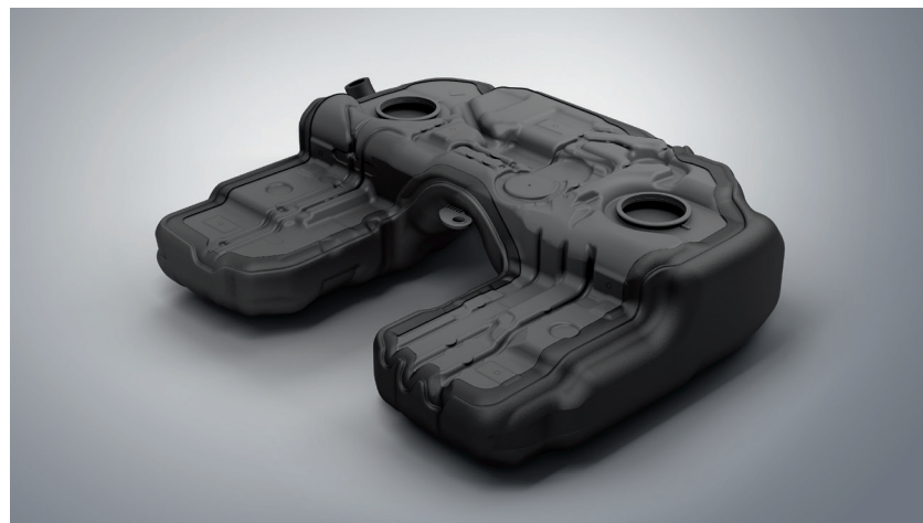
Auslaufhemmender Tank: Die serienmäßig ummantelte Außenhaut des Tanks verschleißt sich nach Beschuss selbstständig und unterbindet das weitere Auslaufen von Kraftstoff.
